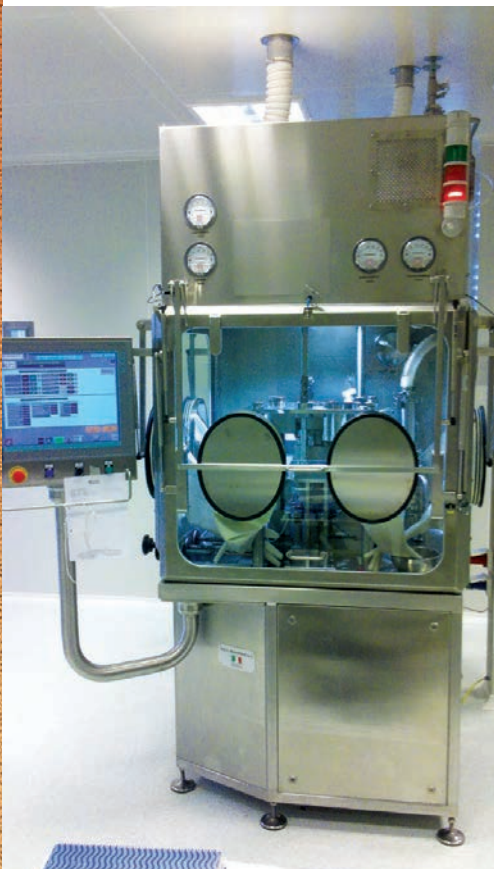
CPR-18 tablettázógép izolátorban az egyik hazai gyógyszergyárban
