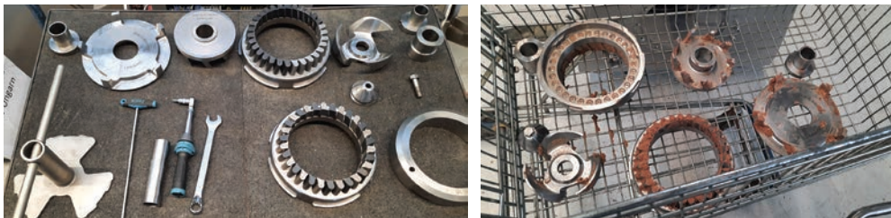
Az aprító rész szerszámai gyártás előtt szétszedve és gyártás után takarítás előtt
