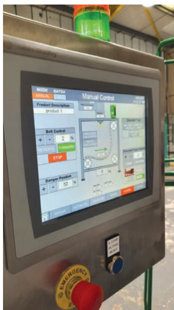
A drázsírozó HMI kezelőfelülete
